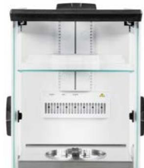
Paravento interno - riduce al minimo l'effetto delle correnti d'aria nella camera di pesata, solo per i modelli da 0,01 mg della serie ABP-A
